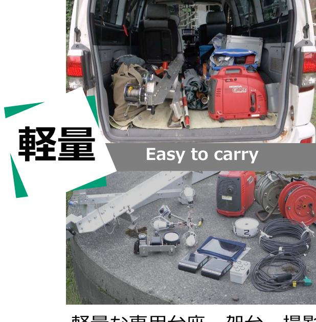
軽量な専用台座、架台、撮影 装置による構成され、ライト バン1台で、人力のみで資材 運搬が可能です。
