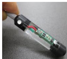
圧力センサ部 Φ13mm 長さ 75mm
