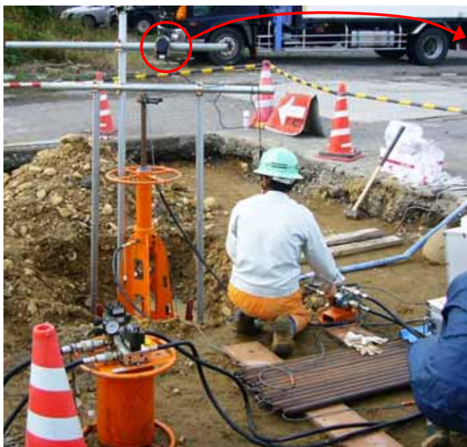
小型貫入装置による三成分コーン貫入試験状況
