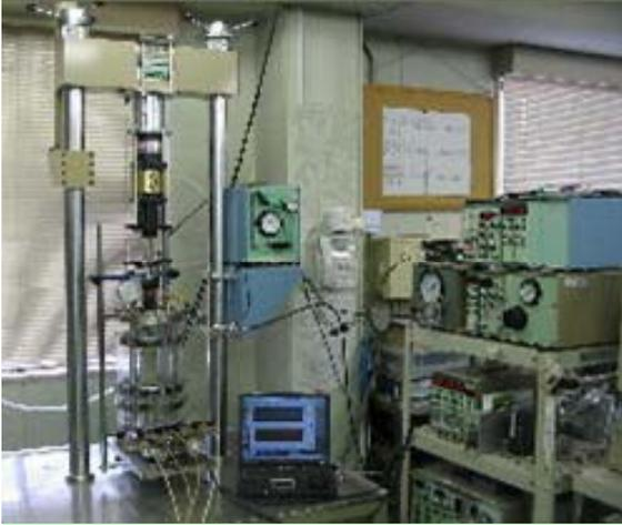
**装置概要:** (静的)一軸圧縮試験、三軸圧縮試験、Ko圧密、Ko圧密非排水三軸圧縮試験、三軸クリープ、静的繰返し試験に対応
