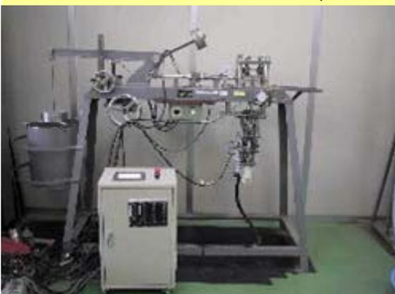
**装置概要:** 圧密定圧、圧密定体積せん断に対応
