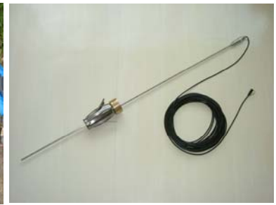
地中用ターゲットと磁歪式変位センサー (写真のセンサーは 1m 計測用)
