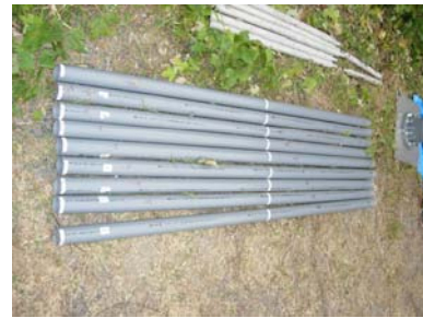
ターゲット押し込み管 (VP50 ボックスネジ加工)
