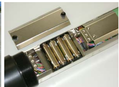
ロガー内部の電池ユニット (単三形乾電池 4 本)
