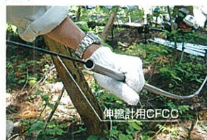
DI ガイド管へCFCCの挿入
