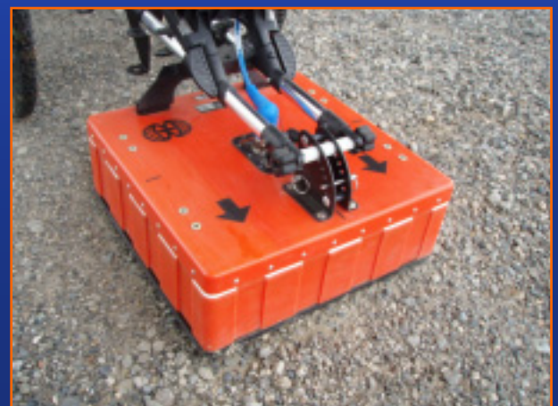
地中レーダーアンテナ(270MHz)
